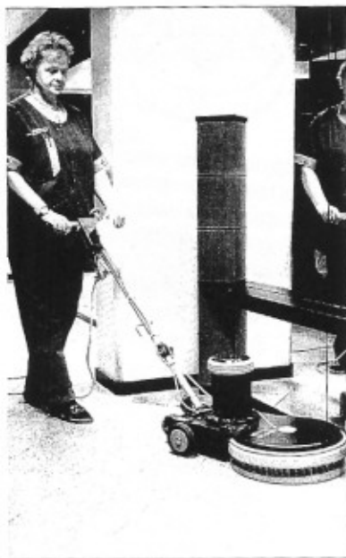
Большинство распылителей на высокоскоростных машинах для полировки полов наносит нужную дозу чистящего средства и средства по уходу на центр диска, откуда они распространяются на весь диск.
